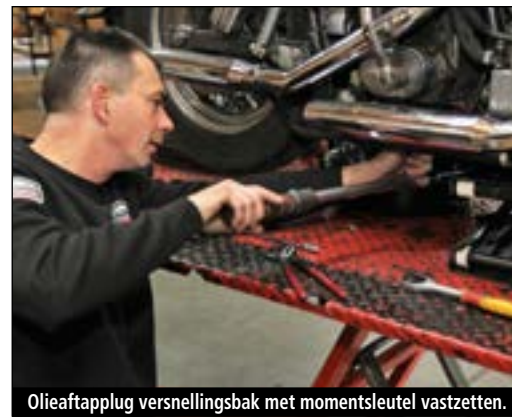
Olieaftapplug versnellingsbak met momentsleutel vastzetten.
