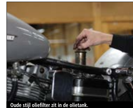
Oude stijl oliefilter zit in de olietank.
