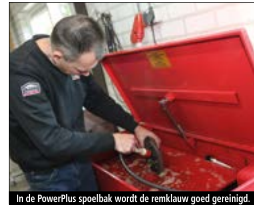
In de PowerPlus spoelbak wordt de remklauw goed gereinigd.
