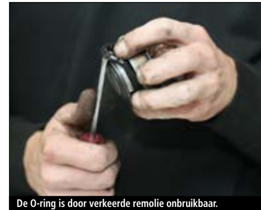
De O-ring is door verkeerde remolie onbruikbaar.
