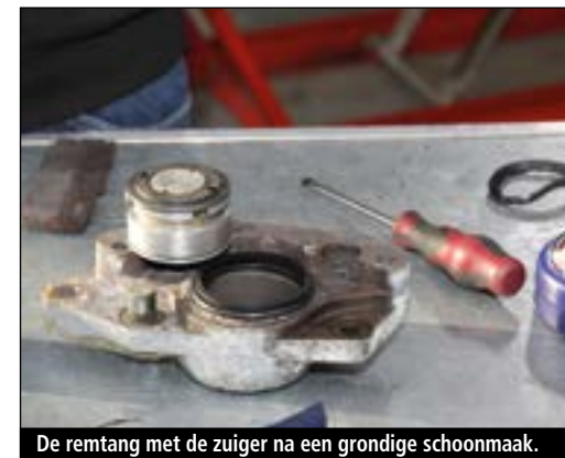
De remtang met de zuiger na een grondige schoonmaak.
