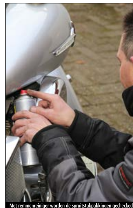
Met remmenreiniger worden de spruitstukpakkingen gechecked.
