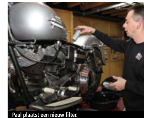
Paul plaatst een nieuw filter.
