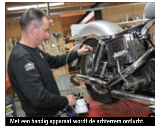
Met een handig apparaat wordt de achterrem ontluicht.
