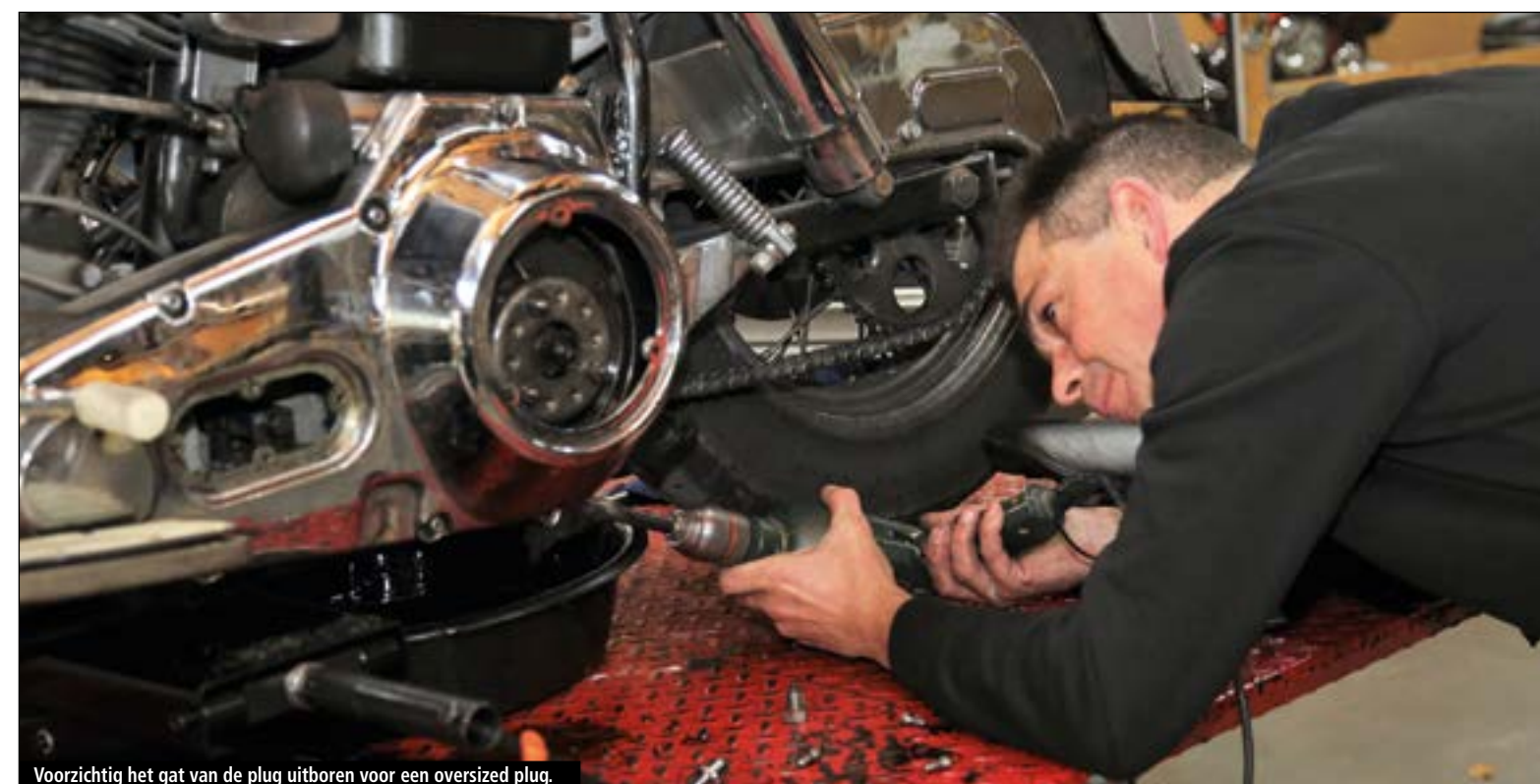
Voorzichtig het gat van de plug uitboren voor een oversized plug.
