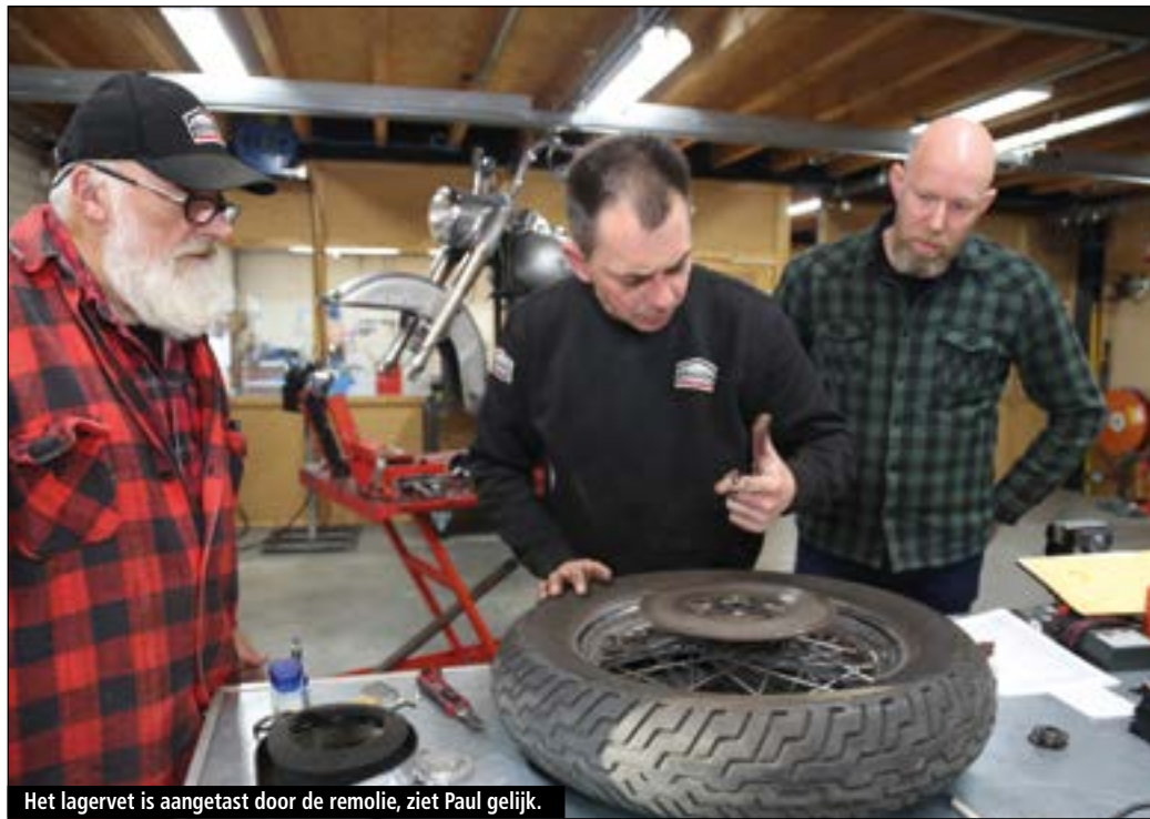
Het lagervet is aangetast door de remolie, ziet Paul gelijk.
