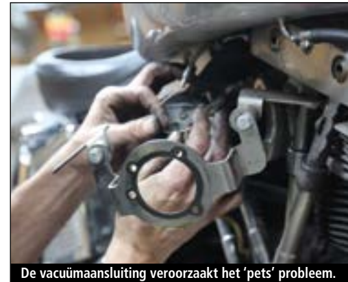
De vacuümaansluiting veroorzaakt het 'pets' probleem.
